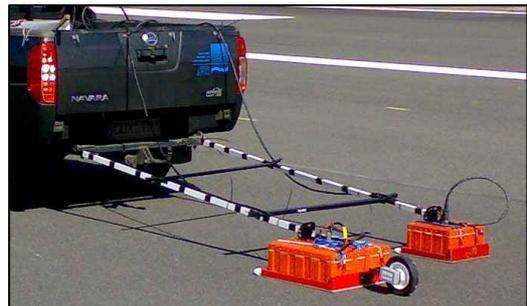
**Sackungen, Rissbildungen, Verdichtungsdefekte, mangelnde Stabilitäten, schadensinitiiierende Wasserstände oder Verbundverluste zwischen Asphaltlagen oder zwischen Ober- und Unterbeton** werden nach Lage, Tiefe und Ausdehnung eingemessen.
